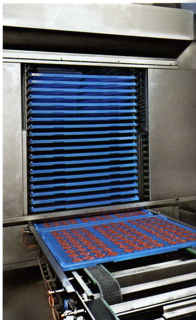
Obr. č. 16: Plátky salámů na sušících rostech v lince QDS (pramen: Metalquimia Španělsko)
